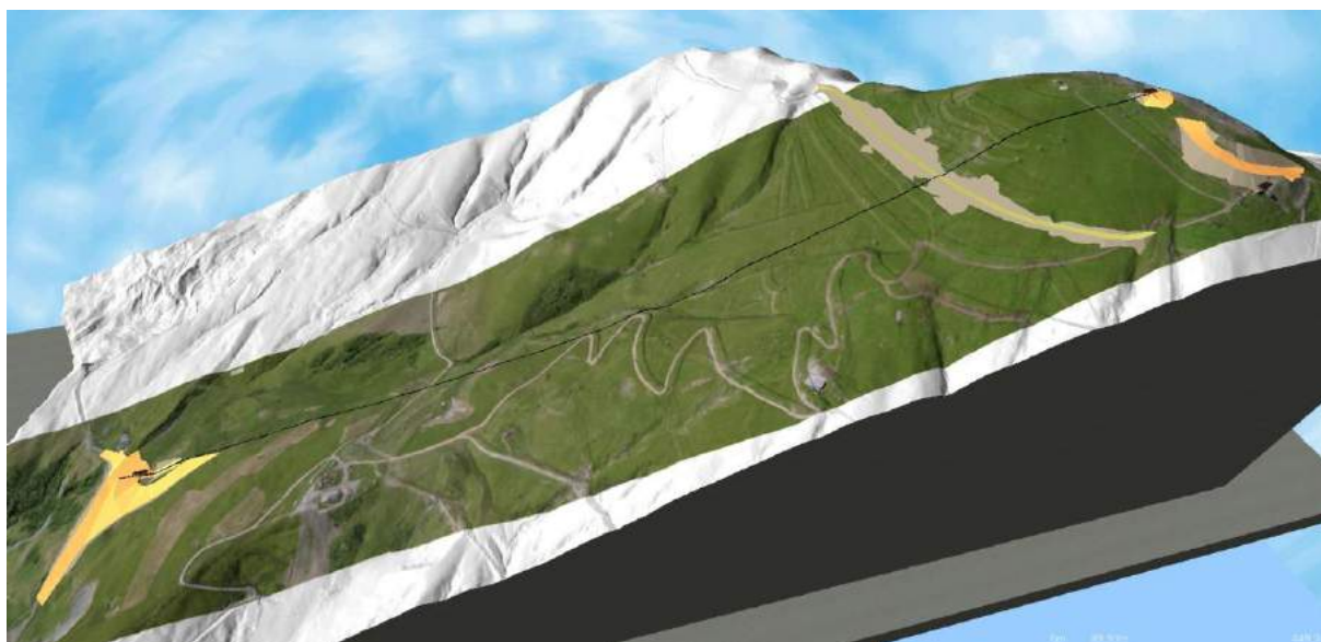
Le modèle numérique de terrain utilisé pour la conception des terrassements.
